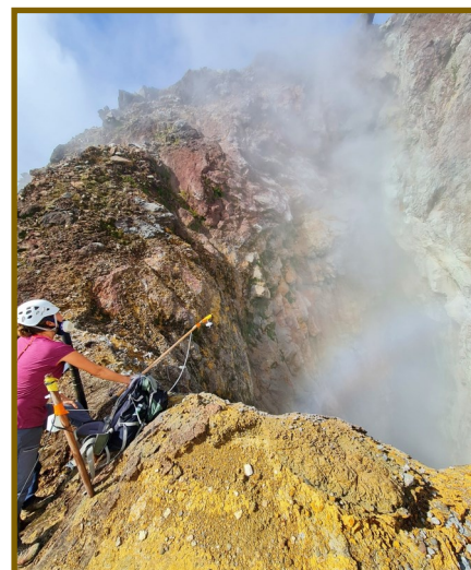
Mesure de la composition chimique du panache volcanique de la Soufrière, au niveau du Gouffre 1956. Mesure effectuée par MultiGAS par l'équipe de l'OVSG (gaz étudiés : H 2 O, CO 2 , SO 2 , H 2 S et H 2 ). (Crédit photo OVSG-IPGP)
